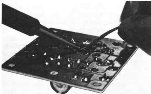
Bild 2.9: Auslöten eines Bauelements mit Hilfe von Lötlitze.
